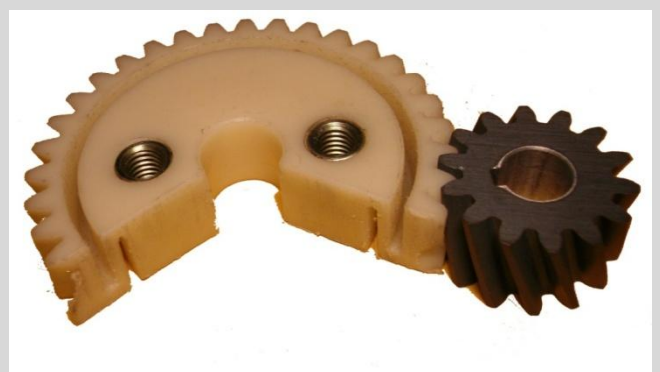
Bild 3 Stirnradpaar: Kunststoffzahnrad aus PA 12G aufgeschnitten. Zu sehen ist das mäanderförmige Profil. Als Gegenrad ein Aluminium coatedes Stirnrad. Normverzahnung Modul=2mm; mit \alpha=20^\circ ; \beta=20^\circ ; Kunststoffzahnrad x=+0,5 ; Aluzahnrad x=0 ;
